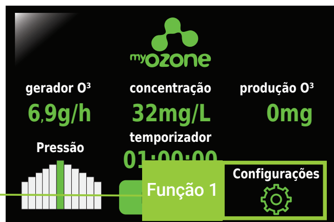
Figura 17: Tela LCD do Gerador
