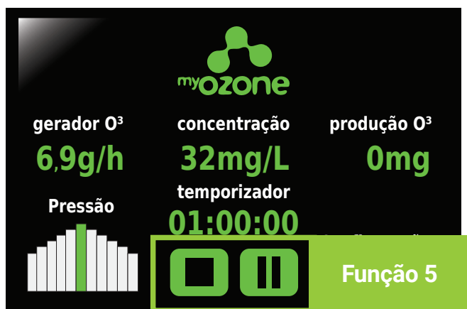
Figura 23: Tela LCD do Gerador
