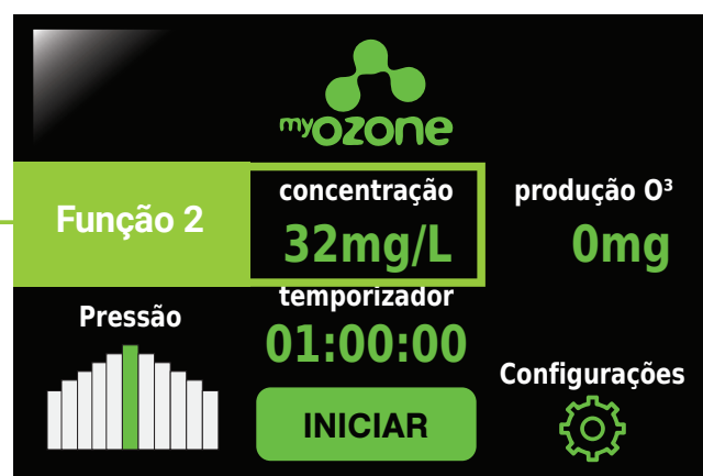
Figura 19: Tela LCD do Gerador
