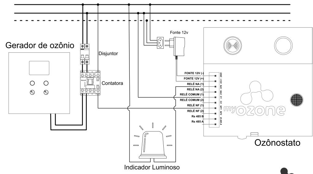
Diagrama Funcional ligação elétrica Ozonostato controlando Gerador de Ozônio
