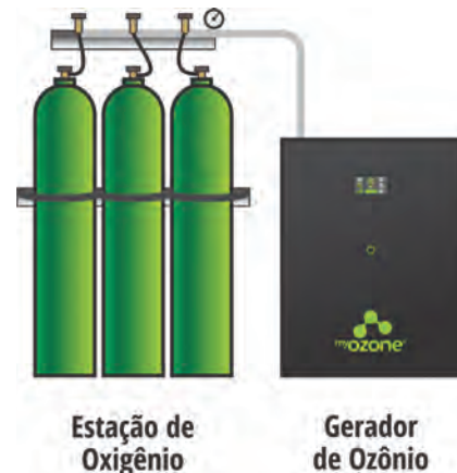
Figura 15: Sistema de Produção de Ozônio com Cilindro de Oxigênio
